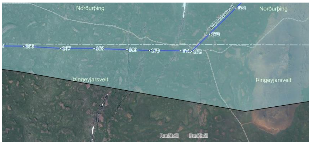
Mynd 4.7 Hér sést hvernig nyrsti hluti strengleiðarinnar meðfram gamla Þeistareykjavegi lendir innan fjarsvæðis vatnsverndar þar sem strengurinn tengist í mastur 172. Mynd: Kortasjá Norðurþings.
